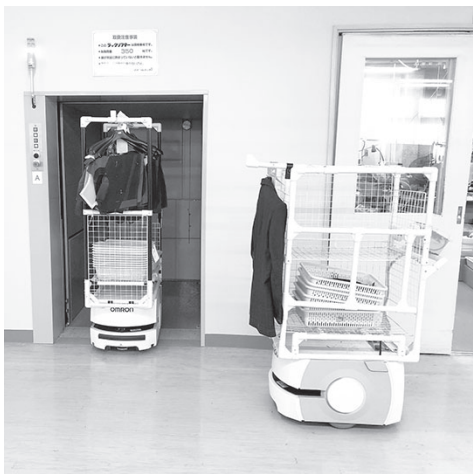
エレベーターを昇降する自動搬送機
